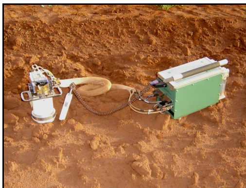
Figura 3. Câmara de solo inserido sobre o colar de PVC (esquerdo) com sensor de temperatura inserido no interior do solo (centro).
